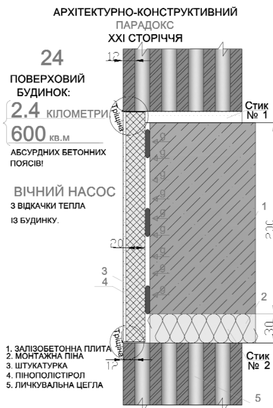
Рис. 3. Вузол стику стіни з перекриттям
